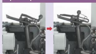
La présence d'un commutateur permet de passer facilement le boucleur supérieur en 2 ou 3 fils.
