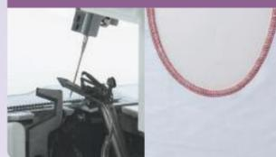
Contrairement aux modèles conventionnels, la distance entre l'aiguille et le couteau a été ramenée à 9.95 mm ! (modèle conventionnel : 15.5 mm). Cela vous autorise des courbes magnifiques avec un rayon plus petit.
