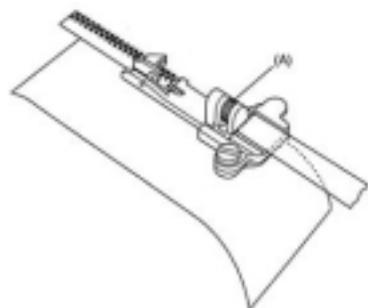
Ce pied est utilisé pour la pose d'élastique aux vêtements et il permet l'ajustement de la tension de l'élastique selon le besoin. Ce pied peut également être utilisé pour la pose des rubans de renfort pour éviter l'étirement des tissus.
