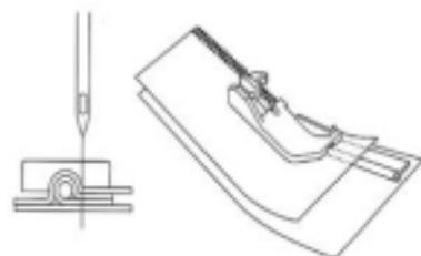
Ce pied presseur permet de poser des passepoils entre deux épaisseurs de tissu.
