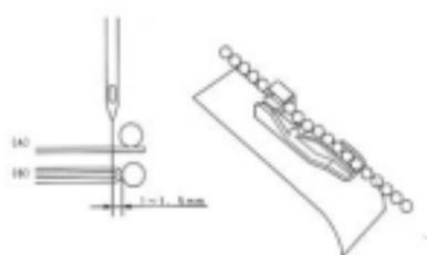
Ce pied est utilisé pour la pose de perles, paillettes, etc.
