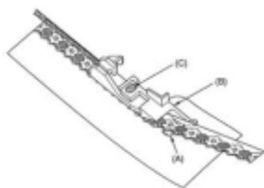
Ce pied est utilisé pour poser la dentelle ou les bordures ensemble ou sur un ouvrage.
