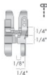
Le pied guide-bord 1/4" avec système IDT™ convient aux coutures d'assemblage d'1/4". Il vous suffit de suivre le guide avec votre bord de tissu. La distance entre l'aiguille et le guide-droit est d'1/4". Le pied guide-bord 1/4" réalise également de parfaites surpiqûres à distance régulière des bordures de blocs lorsque vous quiltez toutes les épaisseurs de votre quilt.
