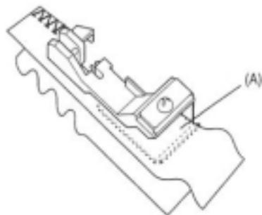
Ce pied convient particulièrement au fronçage lors de la couture de jupes froncées, empiècements, poignets, volants de jupe, etc. Ce pied convient également à l'assemblage de deux épaisseurs de tissu et au fronçage du tissu inférieur en une opération.
