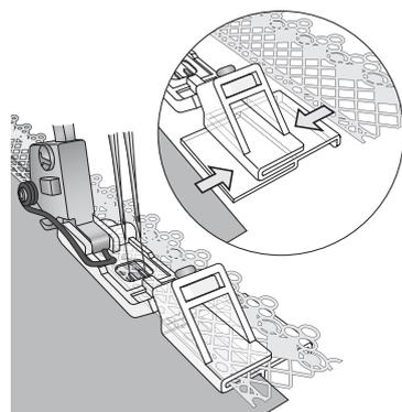
Avec le pied pour bordure plate, vous pouvez ajouter facilement de la dentelle et des bordures aux extrémités du tissu avec un point de recouvrement pour créer des bords décoratifs et des effets magnifiques.
