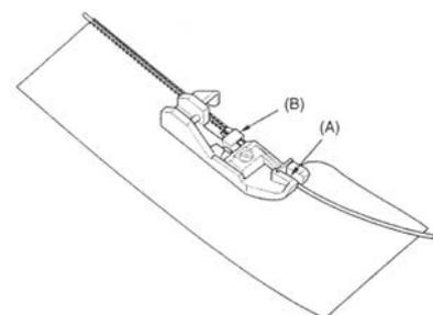
Ce pied est utilisé pour coudre des fils (cordonnets, gouttières en nylon) allant jusqu'à 1,0 mm d'épaisseur. Ceci crée un ourlet ondulé ou renforcé (par ex. pour les robes de mariées ou la pose de volants).
