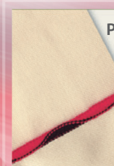
Point de recouvrement 3 fils 3 mm Pour ourler des tissus fins à moyennement épais
